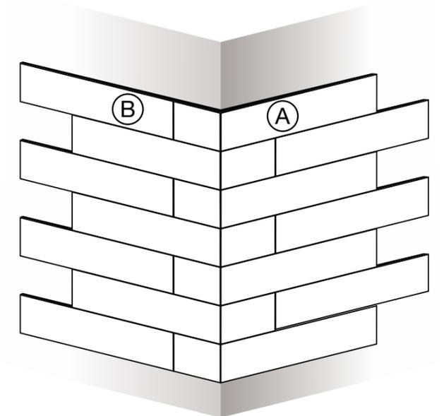
NB: per i tagli necessari si consiglia di tagliare i pezzi lato marca e se possibile con attrezzo munito di disco diamantato a secco o ad acqua.
